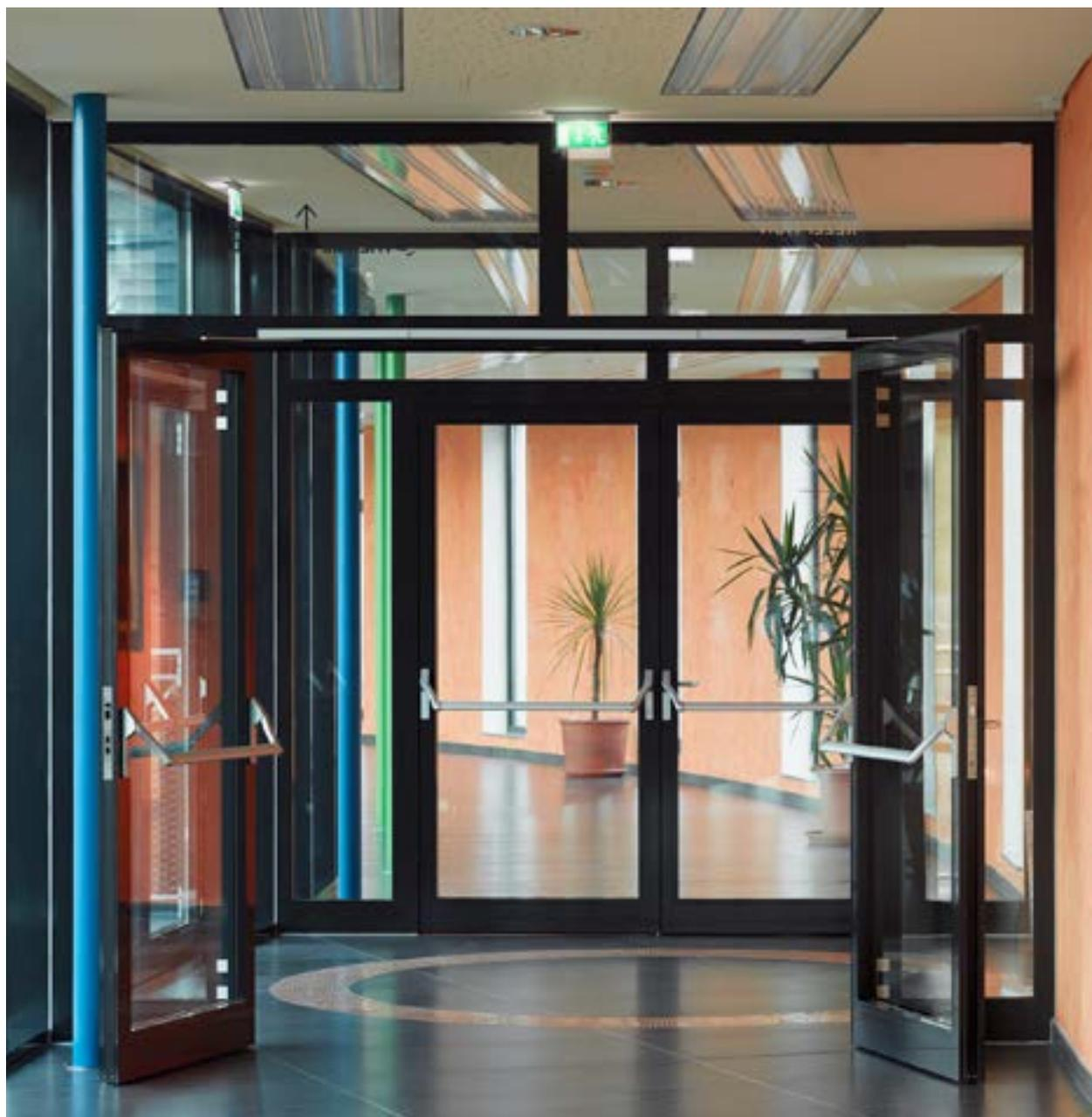
Unsere in ein- oder zweiflügeligen Flucht- und Paniktüren eingesetzten Beschläge sind mit Schloss, Beschlag und Zubehör in kompletten Einheiten geprüft. Als Alternative zu den sogenannten „Panikschlössern“ bietet Hueck zertifizierte Notausgangsverschlüsse mit Drücker nach DIN EN 179 für Gebäude ohne öffentlichen Publikumsverkehr sowie Panikverschlüsse mit horizontaler Betätigungsstange nach DIN EN 1125 für öffentliche Gebäude.
