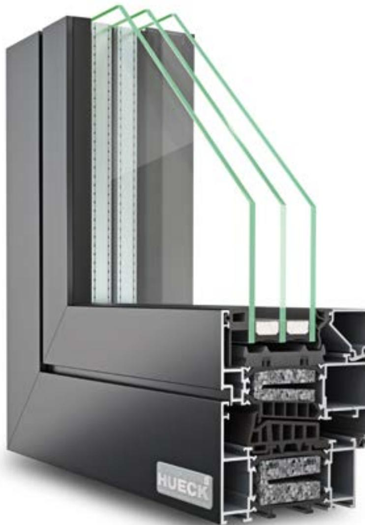
Höchste Energieeffizienz bis zur Passivhaustauglichkeit, architektonische Eleganz und schmale Profilansichtsflächen: Für Lochfenster und Fensterbänder ist HUECK Lambda WS 090 mit seinen geraden Ansichten die ideale Lösung für Projekte mit hohen Ansprüchen an die Wärmedämmung. Durch eine Bautiefe mit 90 mm für den Rahmen und 100 mm für den Flügel wird eine leichte und elegante Optik erzielt. Zudem überzeugt dieser vielseitig einsetzbare Fenstertyp durch Haltbarkeit und sichere Funktion.
